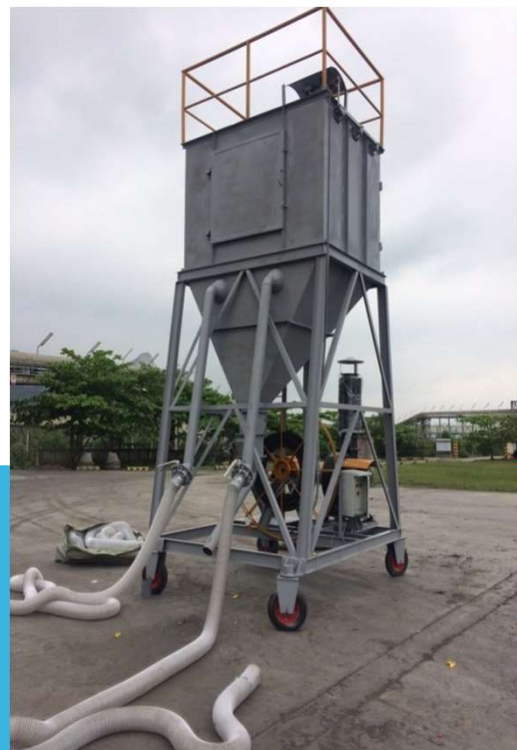
Lọc bụi túi rũ bằng điện
